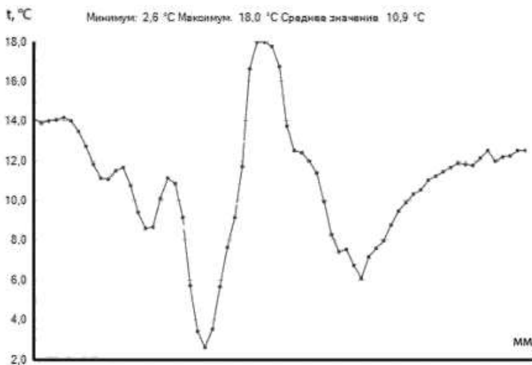
Рисунок Е.1 — Пример проведения тепловизионной съемки внутренней поверхности оконного блока и узла примыкания к стеновой конструкции
